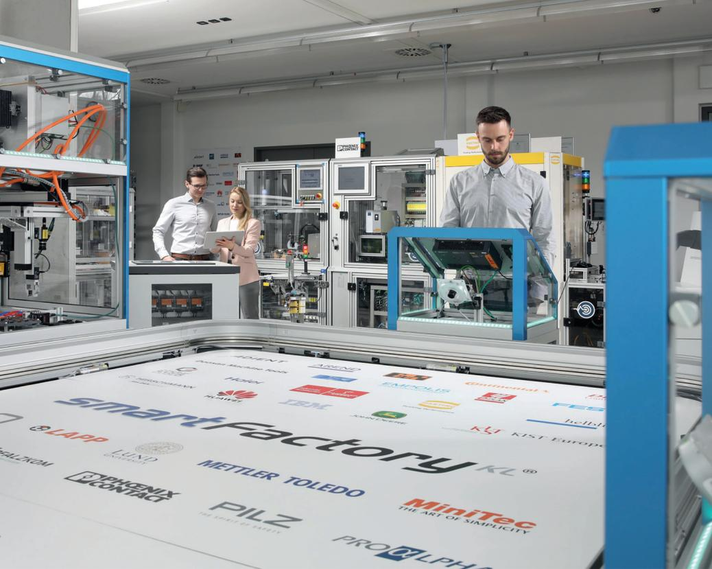
Der Production Level 4 Demonstrator mit seinen autonomen Produktionsmodulen stellt die Weiterentwicklung von Industrie 4.0 dar
