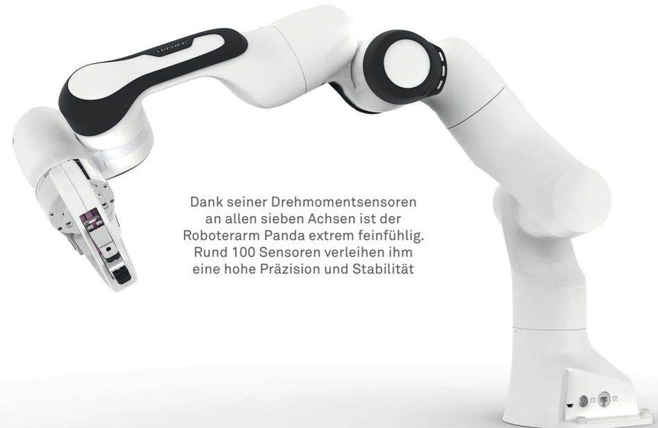
Dank seiner Drehmomentsensoren an allen sieben Achsen ist der Roboterarm Panda extrem feinfühlig. Rund 100 Sensoren verleihen ihm eine hohe Präzision und Stabilität
